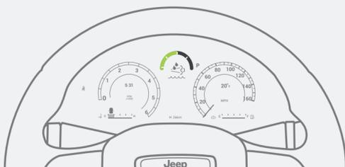
**El primer aviso** se dará cuando se consume el 50% del tanque de ARNOX32. Esto no debe alarmar al conductor, sino informarlo acerca de la necesidad de que debe reabastecer el depósito.
